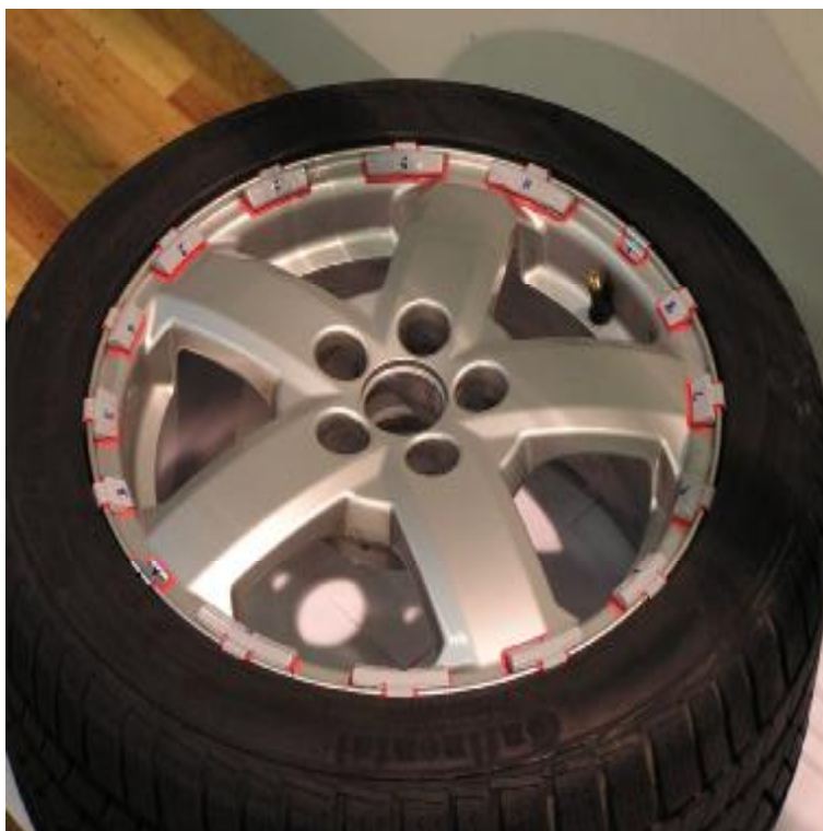
Foto 5 Uspořádání vyvažovacích závaží RE 10 – RE 40 na litém kole
