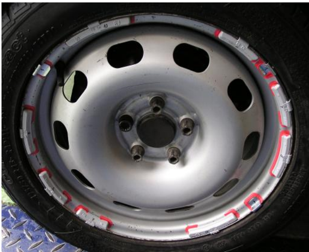
Foto 7 Uspořádání vyvažovacích závaží RU 5-60 na ocelovém diskovém kole
