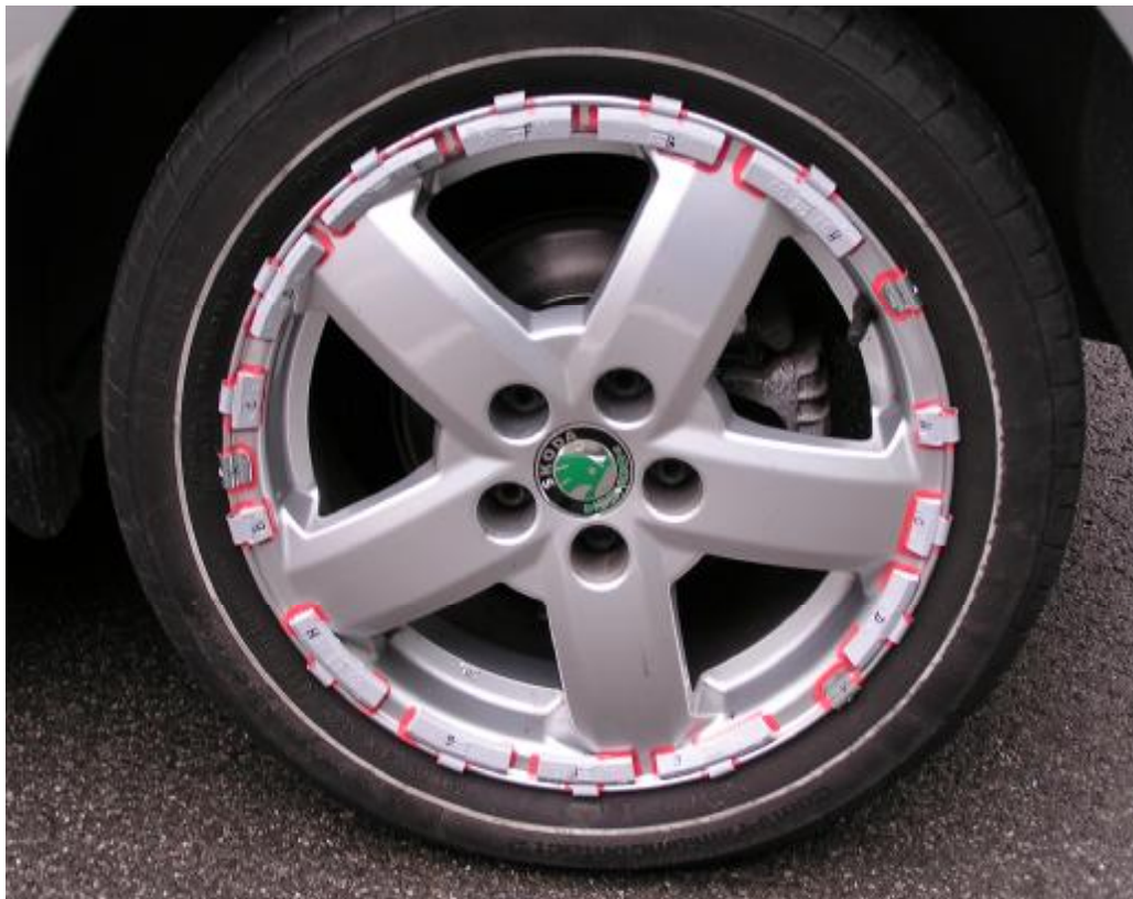
Foto 6 Uspořádání vyvažovacích závaží RE 10,15,40,45,50,55,60, na litém kole
