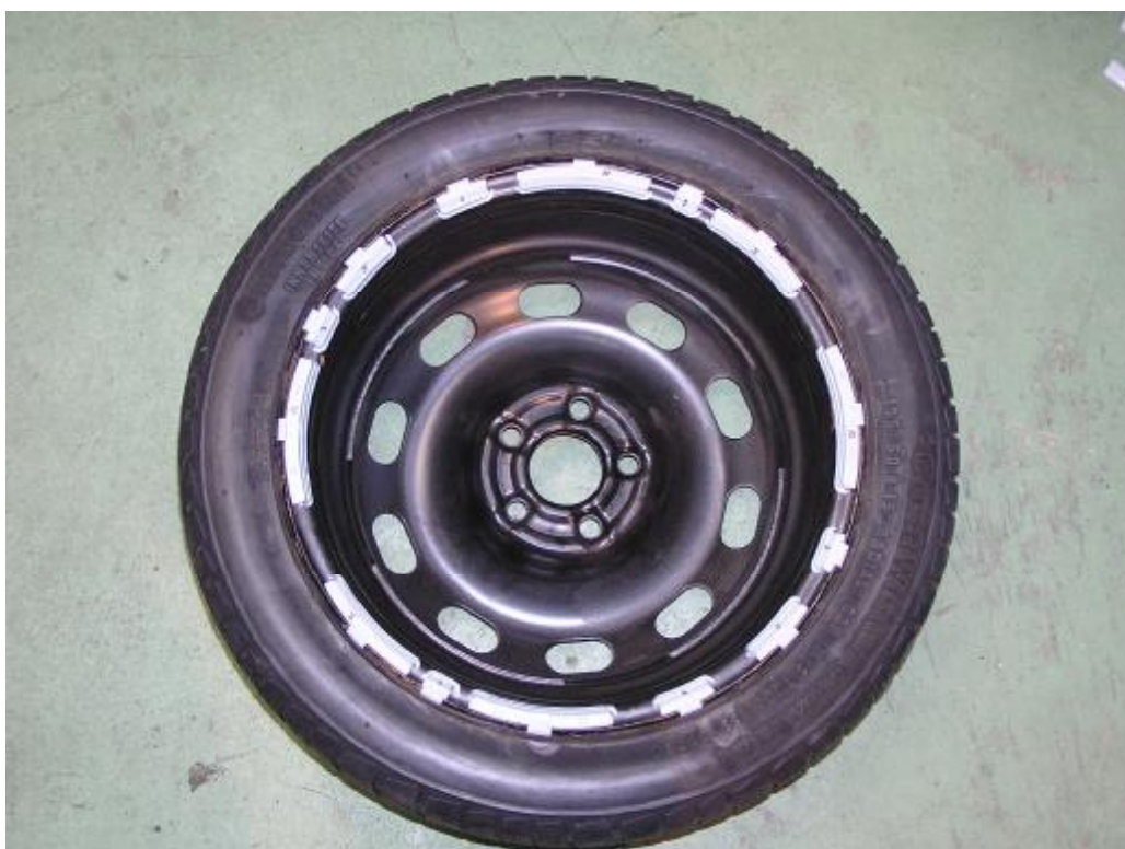
Foto 8 Uspořádání vyvažovacích závaží RU 5-60 na ocelovém diskovém kole
